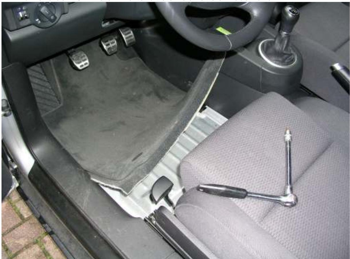
3. ... die zwei 8er XZN Schrauben der Sitzschienen lösen
