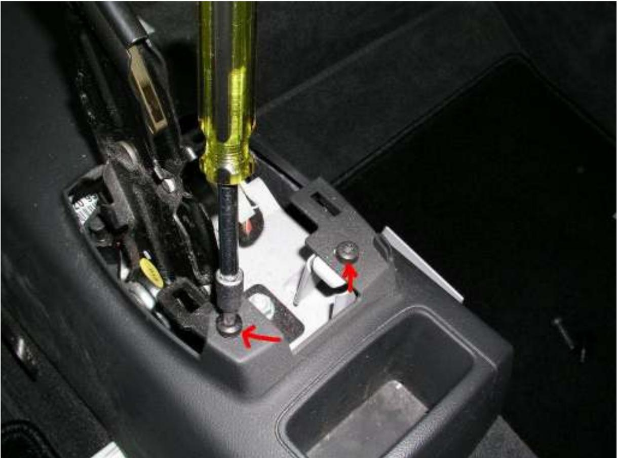
45. 2x TORX vorm Schaltknauf entfernen.
