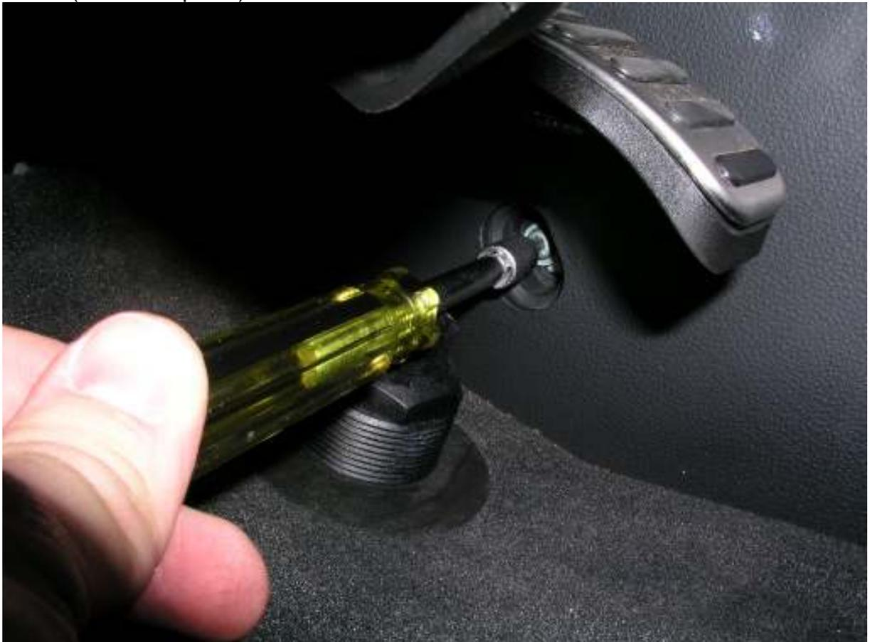
39. Verkleidung hinten ausklipsen und abnehmen. Beifahrerseite analog dazu.
