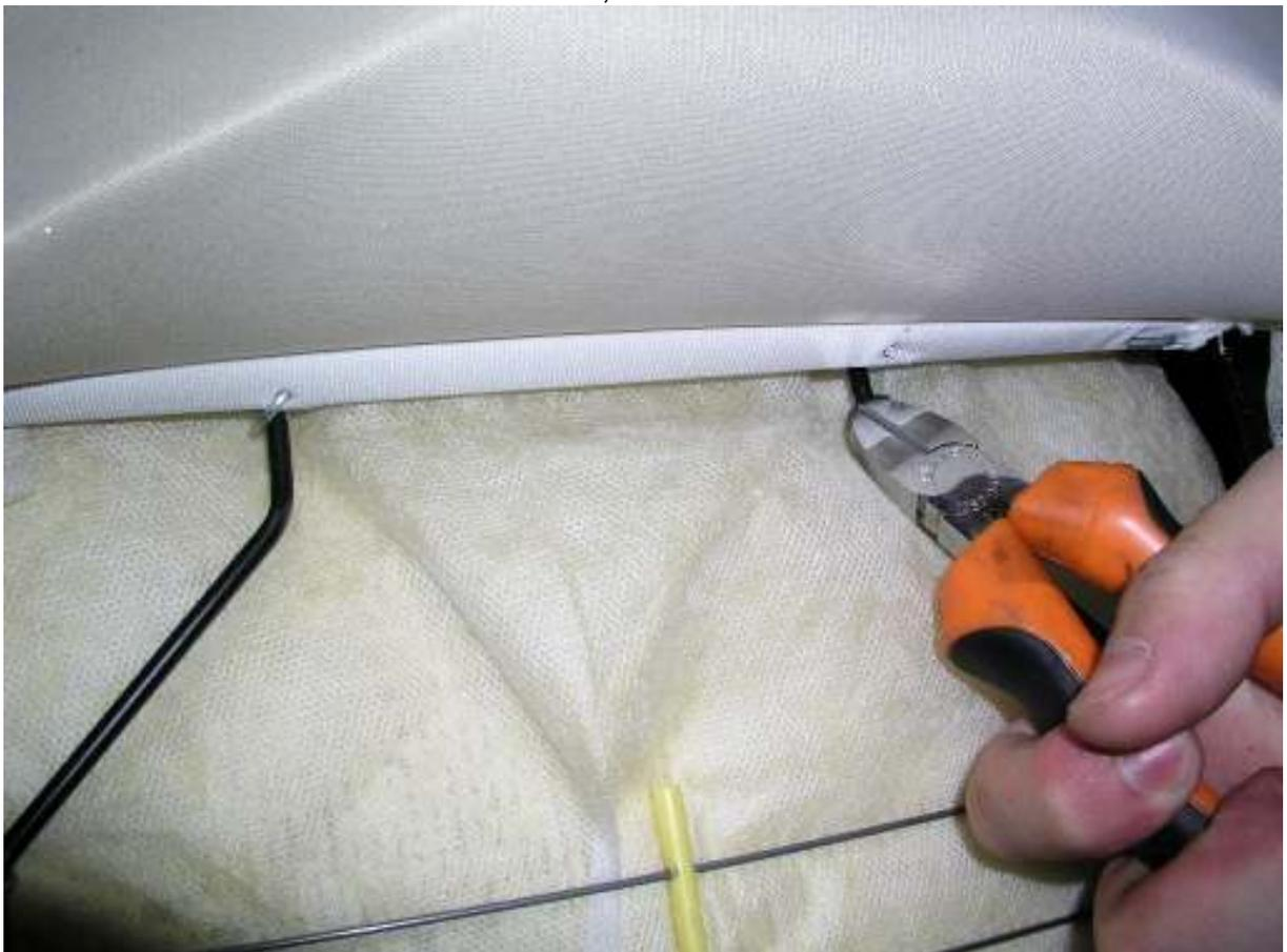
19. Bezug auf der dem Airbag abgewandten Seite hochklappen und die Klammern abkneifen...
