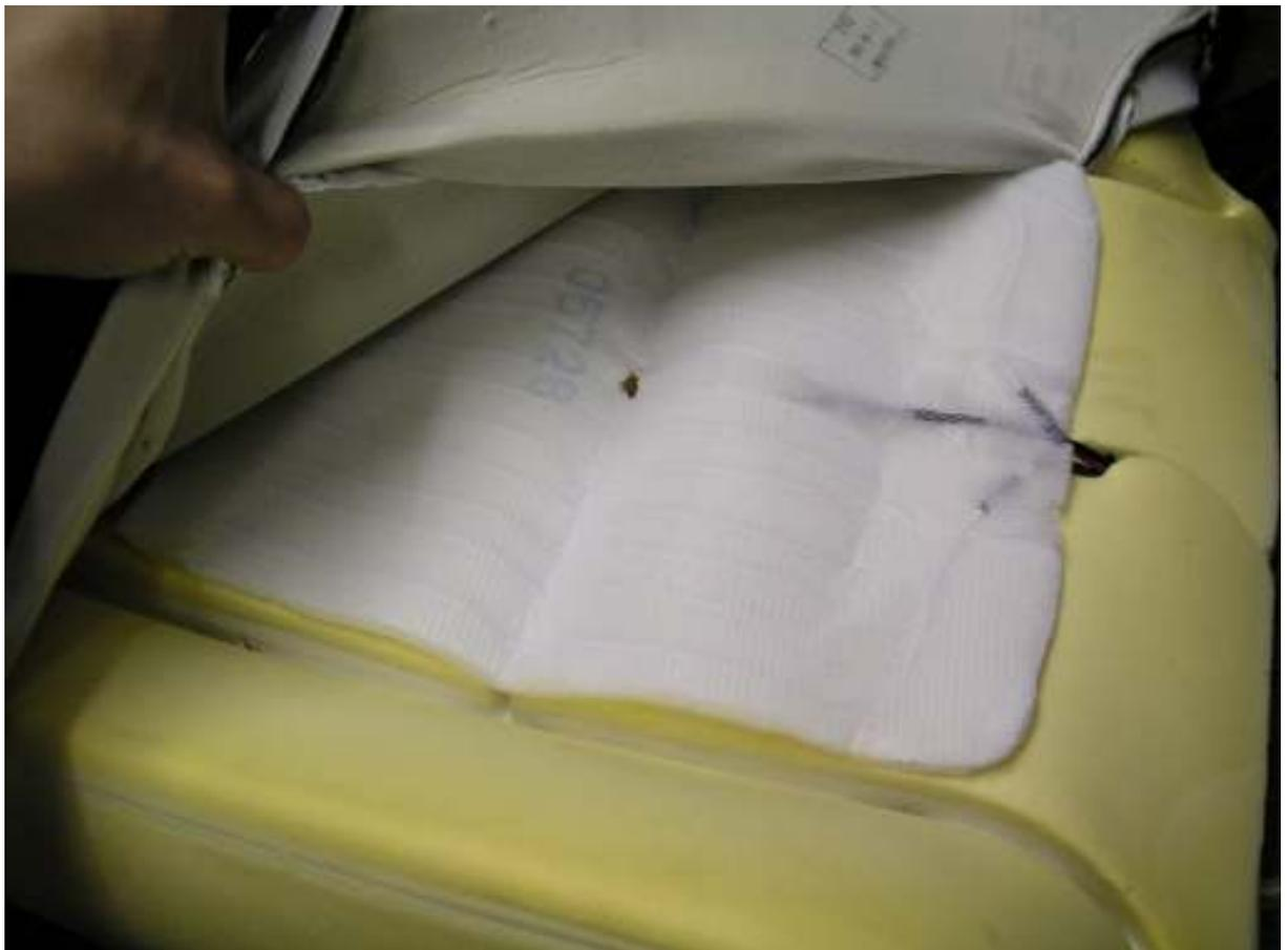
31. An die Stelle der Polstererklammern kommen kleine Kabelbinder. Mit einer kleinen, abgewinkelten Zange kann man die am besten anbringen.
