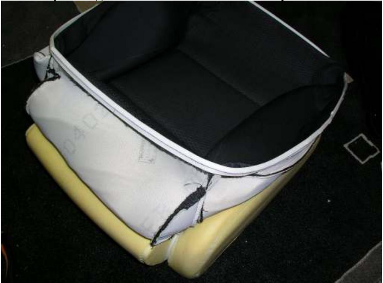
24. Nun bei einem Lehnenelement den Stoff etwas anheben und den Temperaturregler freilegen.
