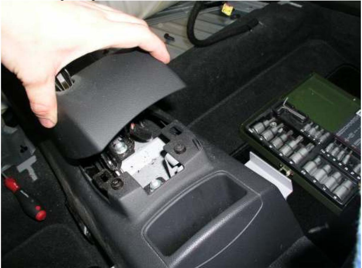
38. Torxschraube unter Abdeckung in der Seitenverkleidung der Mittelkonsole lösen. (Unter Gaspedal).
