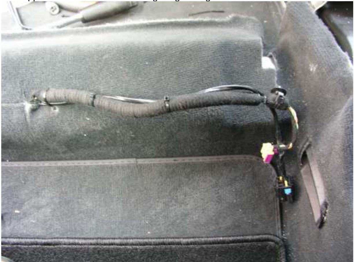
53. Dann wird das Kabel hinter dem Teppich an dem Träger entlang geführt.
