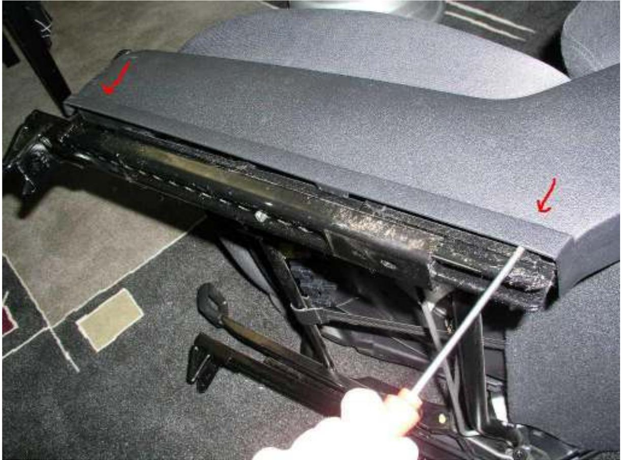
12. 8er XZN zwischen Sitzschale und Höhenverstellung lösen. Versteckt sich hinter Stoff
