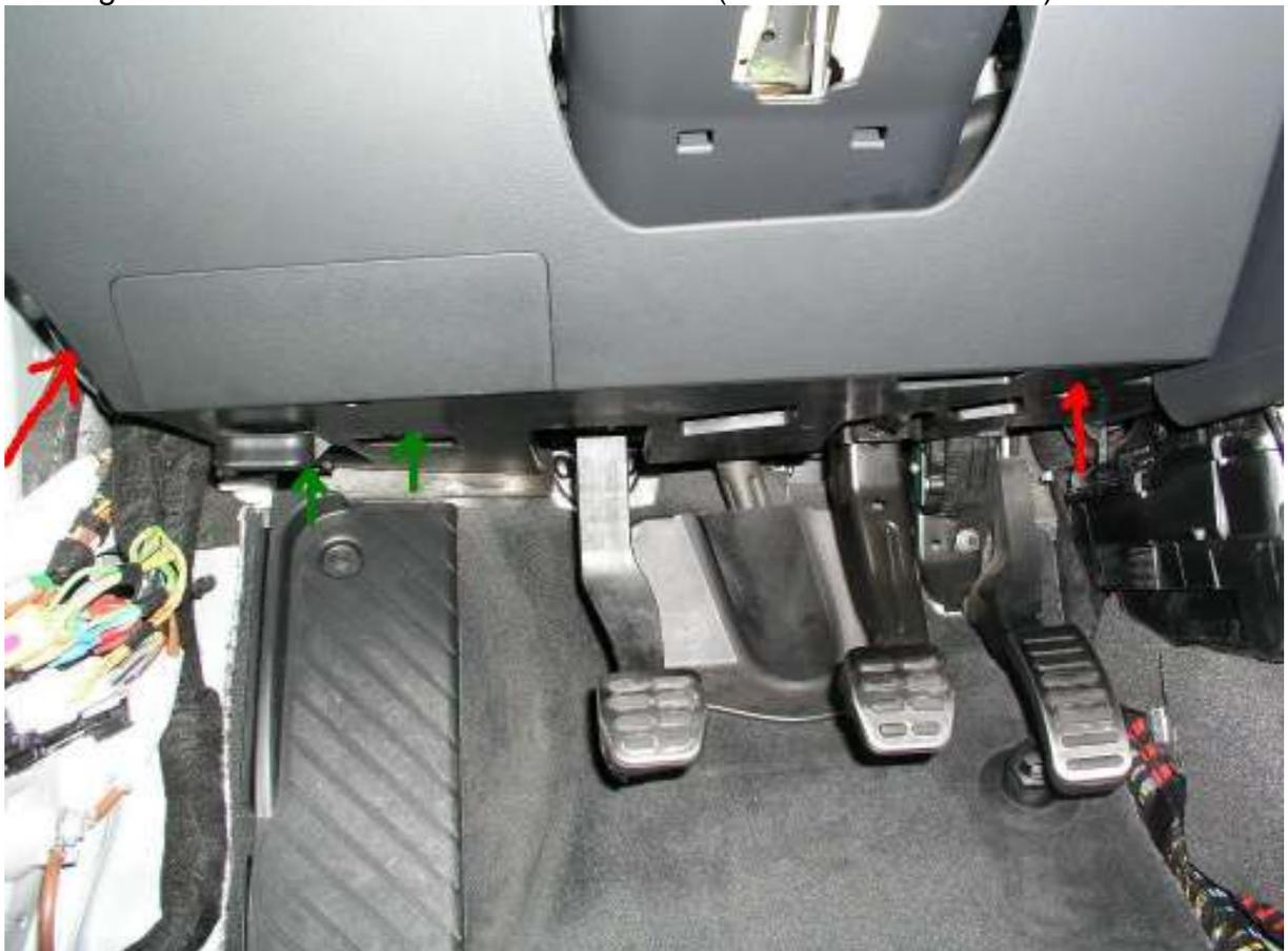
49. 5x 10er SK Muttern lösen und Träger sowie Sicherungskasten lösen.
