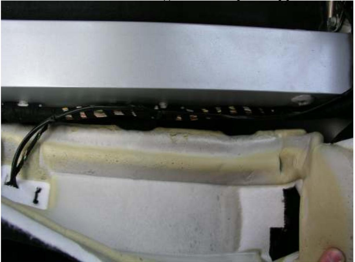
54. 2x SK und 2x TORX lösen und Kabel dahinter verlegen.
