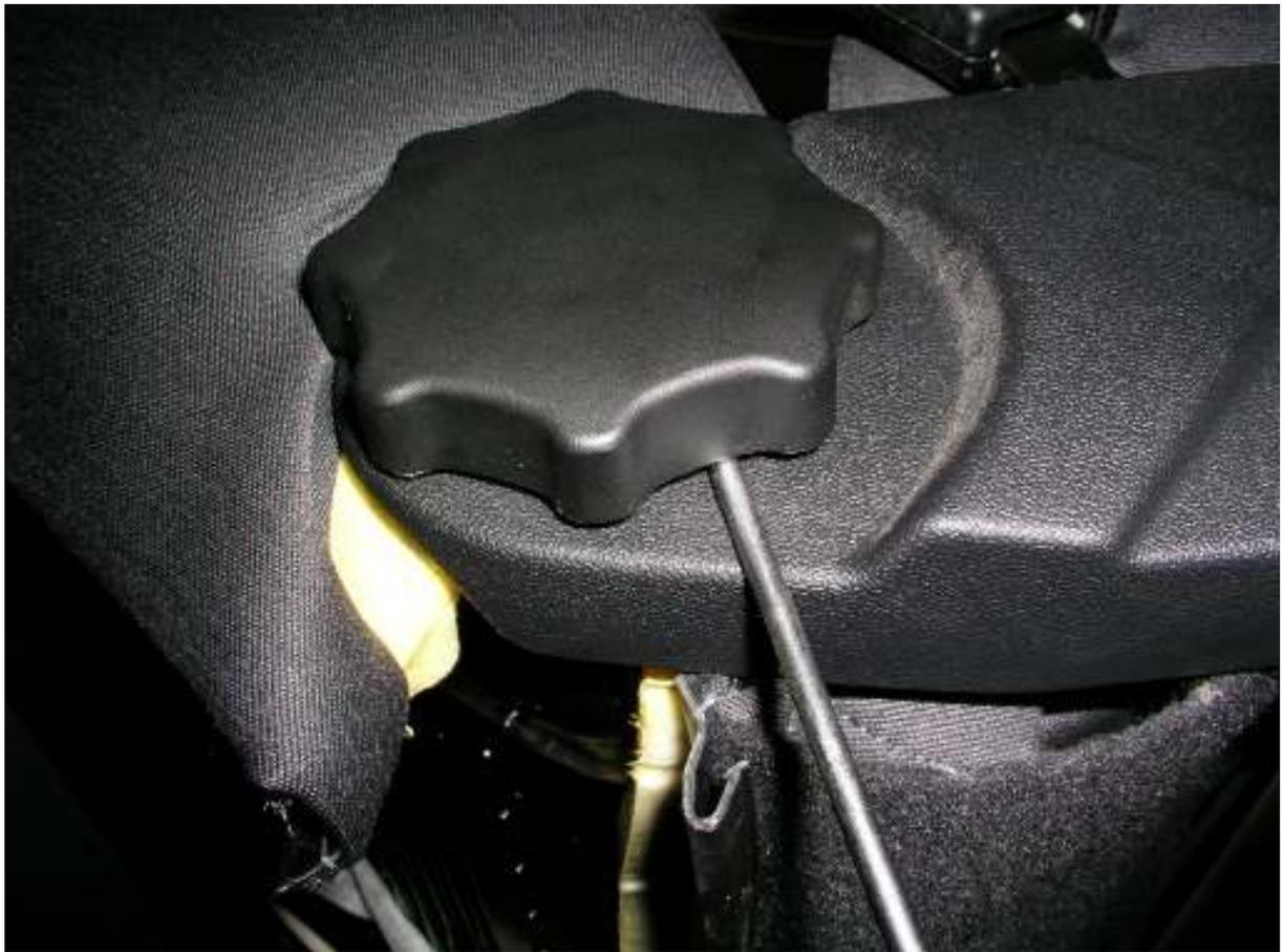
14. Verkleidung unten aushebeln (bis Mj2002 Torxschraube von innen), dann nach oben abziehen.
