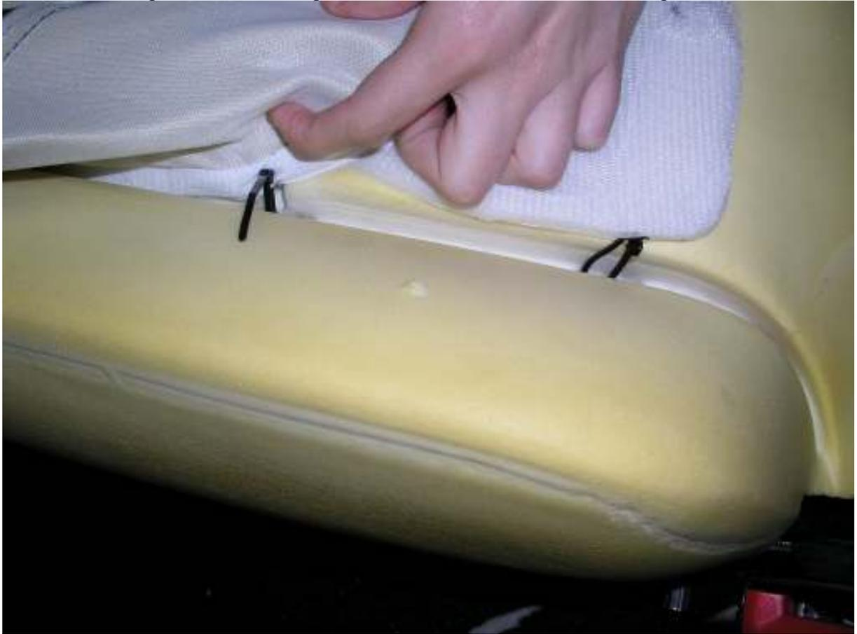
32. Kabel von Heizmatte und NTC wie hier gezeigt am Airbagkabel entlang verlegen.
