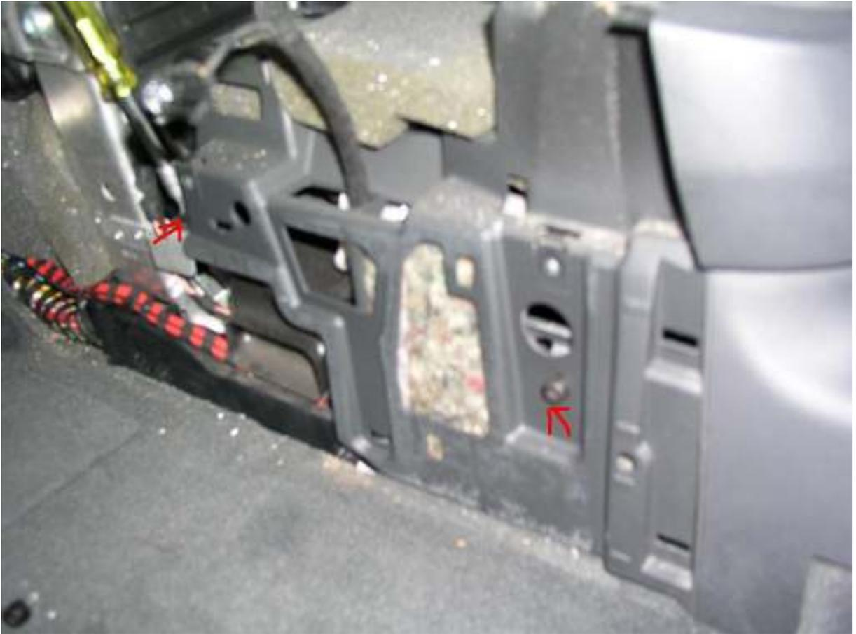
44. 2x TORX auf Höhe der Handbremse entfernen.
