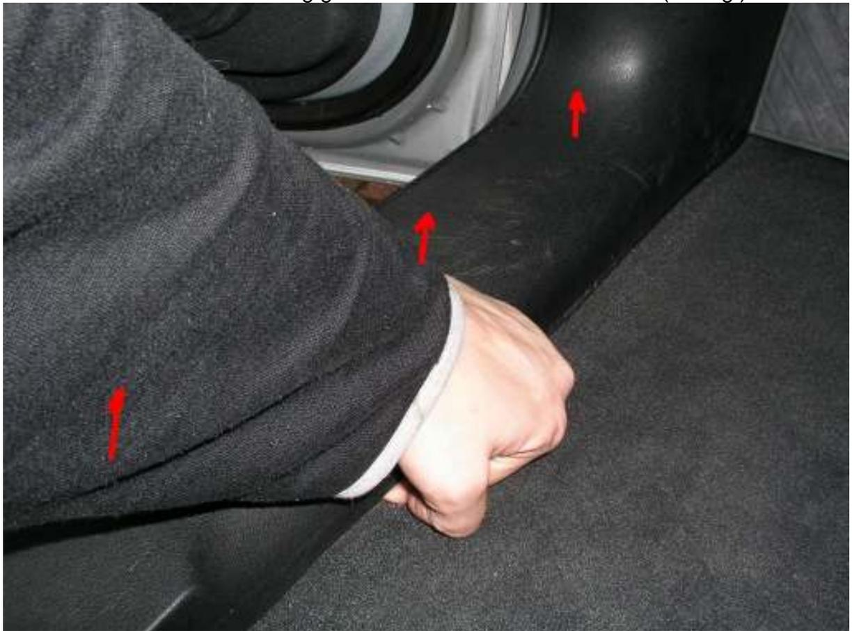
48. 2x Torx lösen und Klappenentriegelung sowie Diagnosestecker aushängen. Oben gleichen und zum Lenkrad hin abziehen. (Vorsicht! Bricht leicht)
