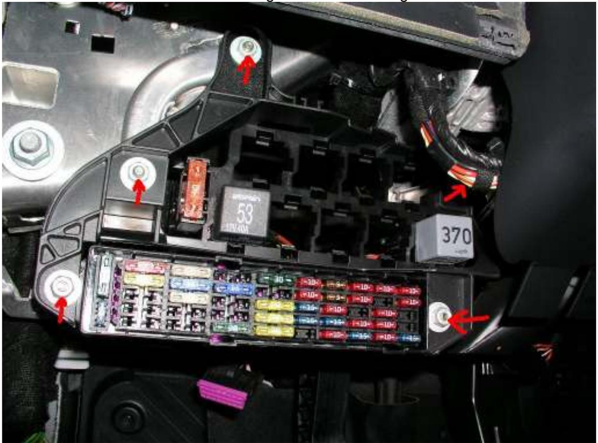
50. Kabelbinder abschneiden und Deckel des Sicherungskastens abnehmen.
