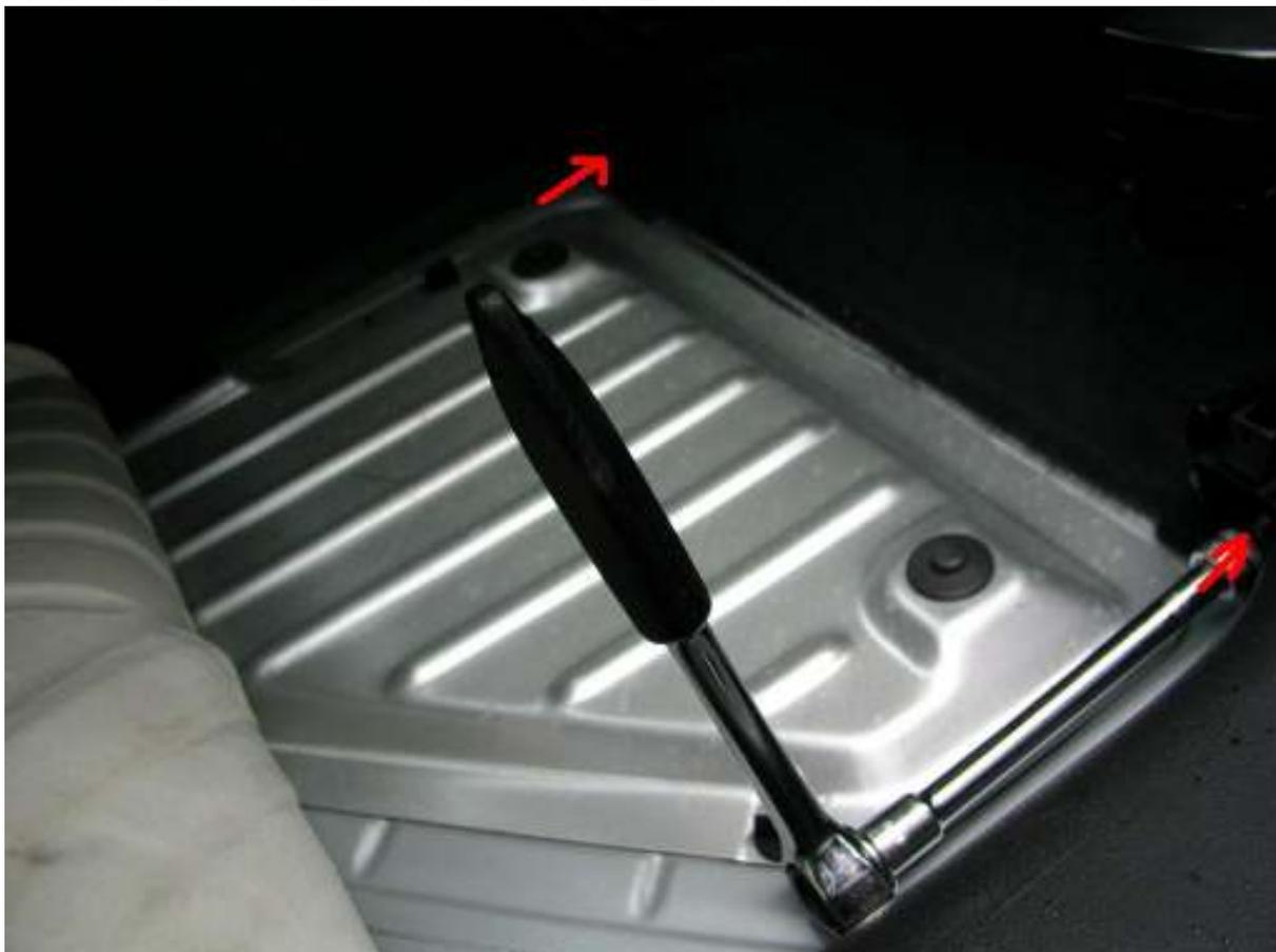
4. Nun den Plastikniet der hinteren Sitzschienenabdeckung lösen und Abdeckung abnehmen.
