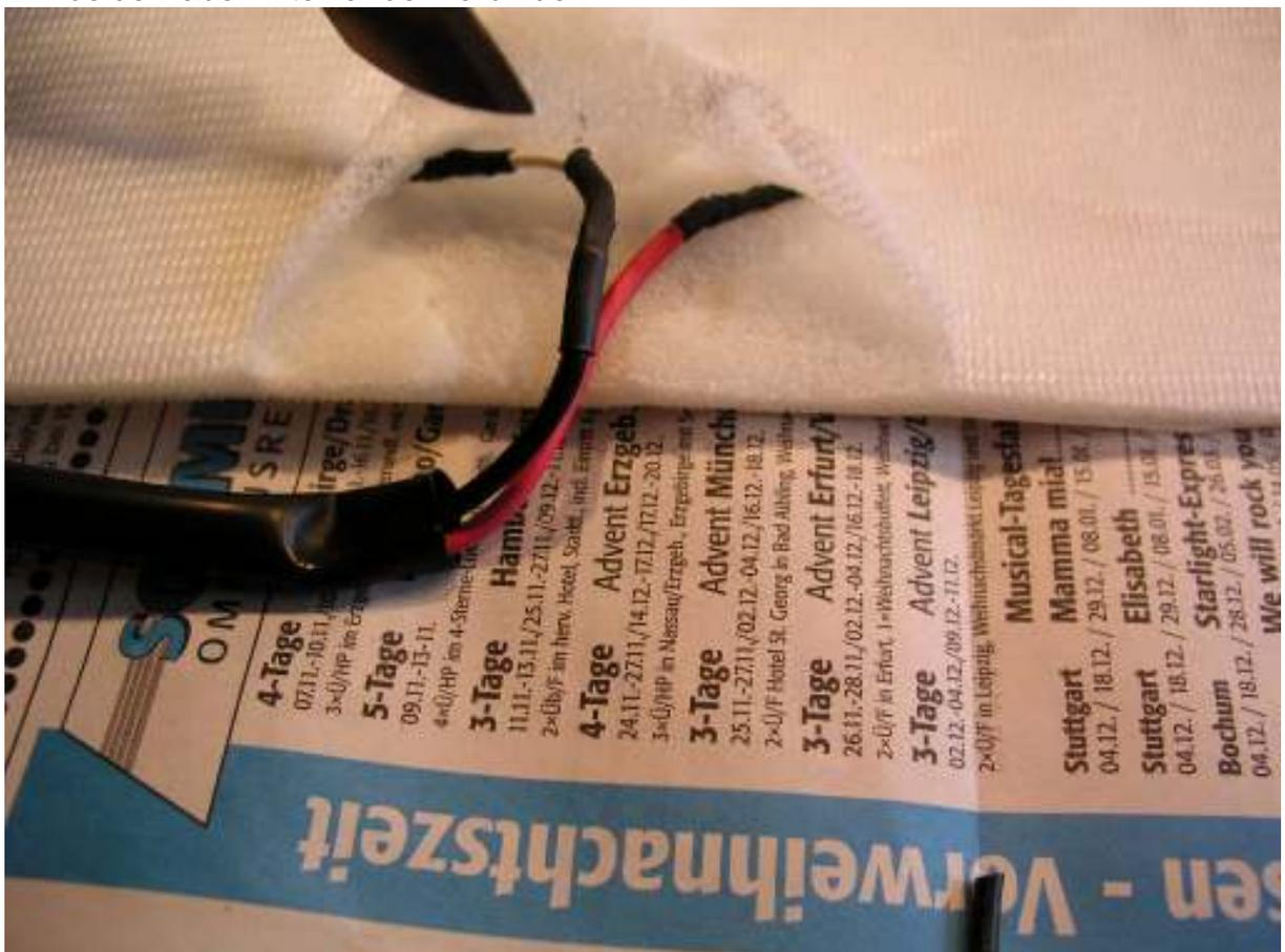
28. Nun den bereits mit Kabel verlöteten und isolierten NTC an die Stelle des Reglers schieben.
