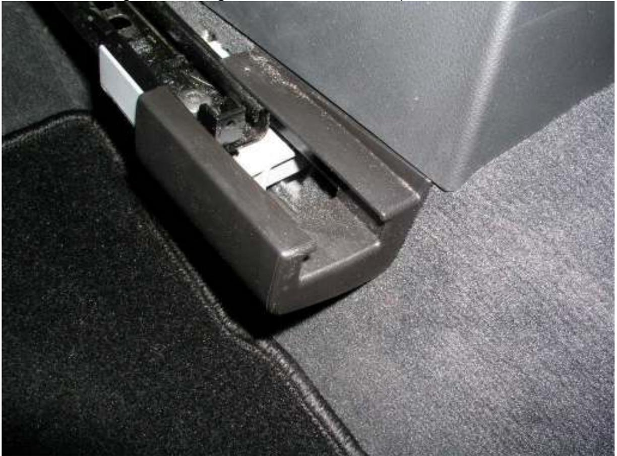
6. Beide 8er XZN Schrauben lösen
