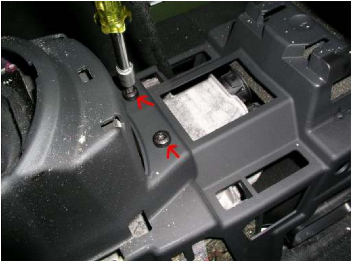
46. Schelle am Schaltknauf aufbiegen und Mittelkonsole abnehmen. Falls nicht möglich, Handbremse ganz fest anziehen.
