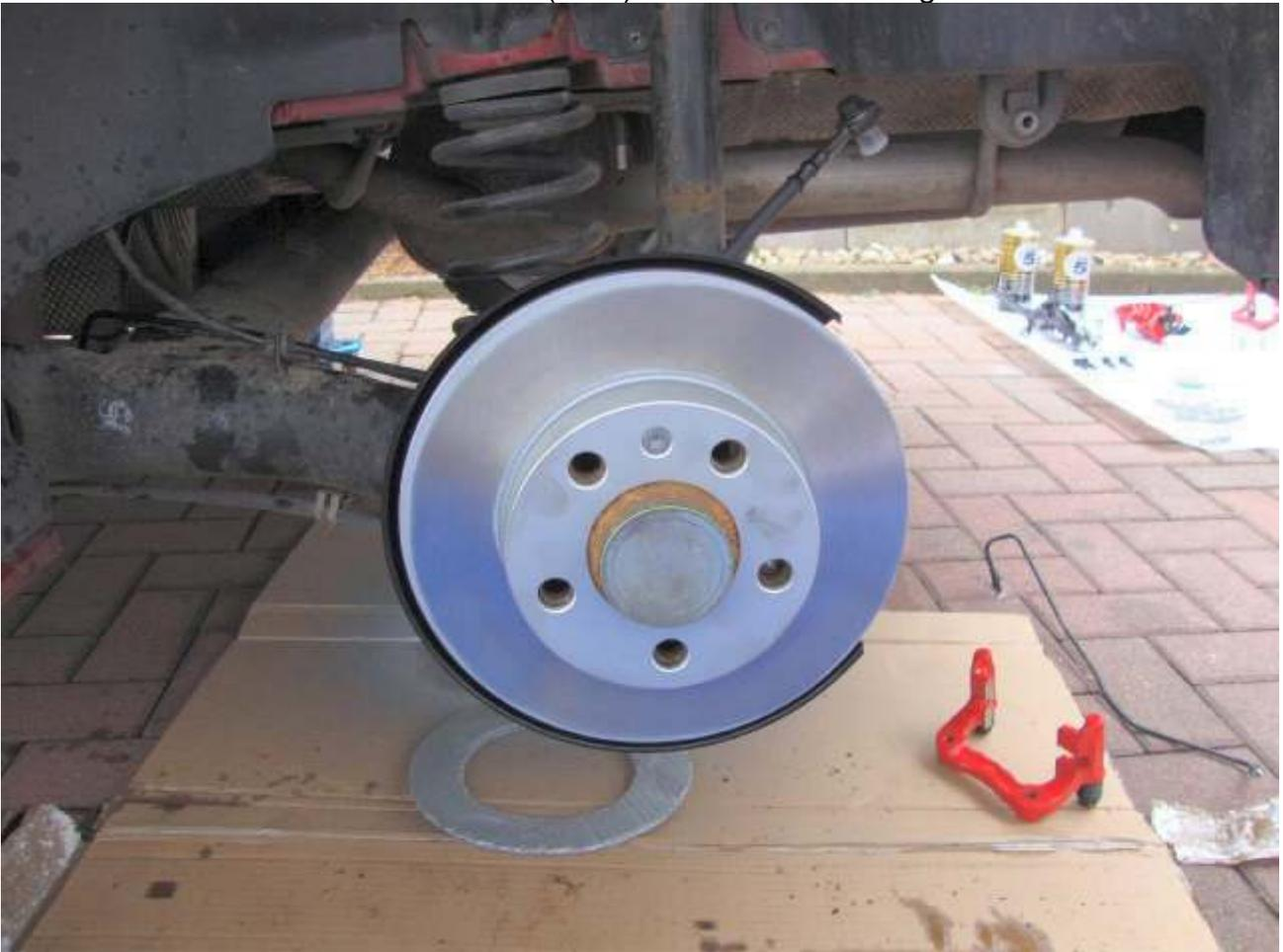
Bremssattelhalter mit 65Nm an Achszapfenaufnahme befestigen.
