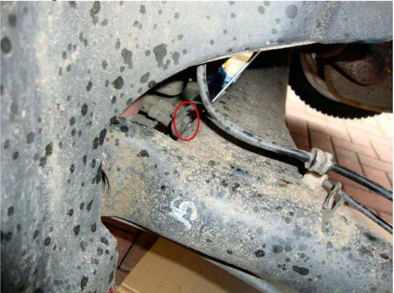
Neue Bremsleitung befestigen und mit 12Nm anziehen.
