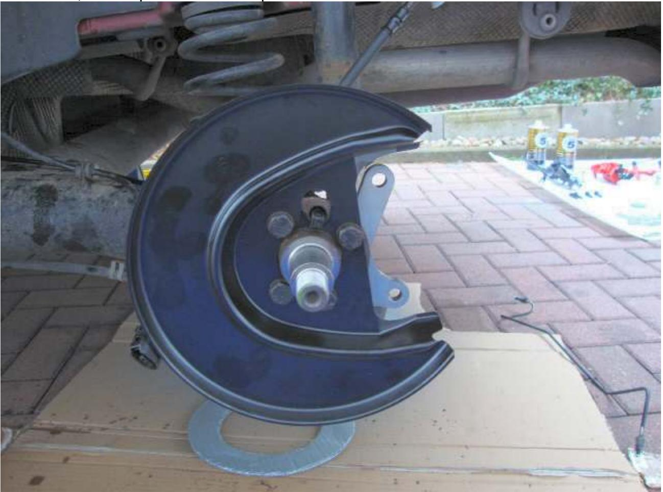
ABS Sensor mit 10Nm anbringen. Stecker muss nur auf der Fahrerseite bearbeitet und mit Kabelbinder gesichert werden.
