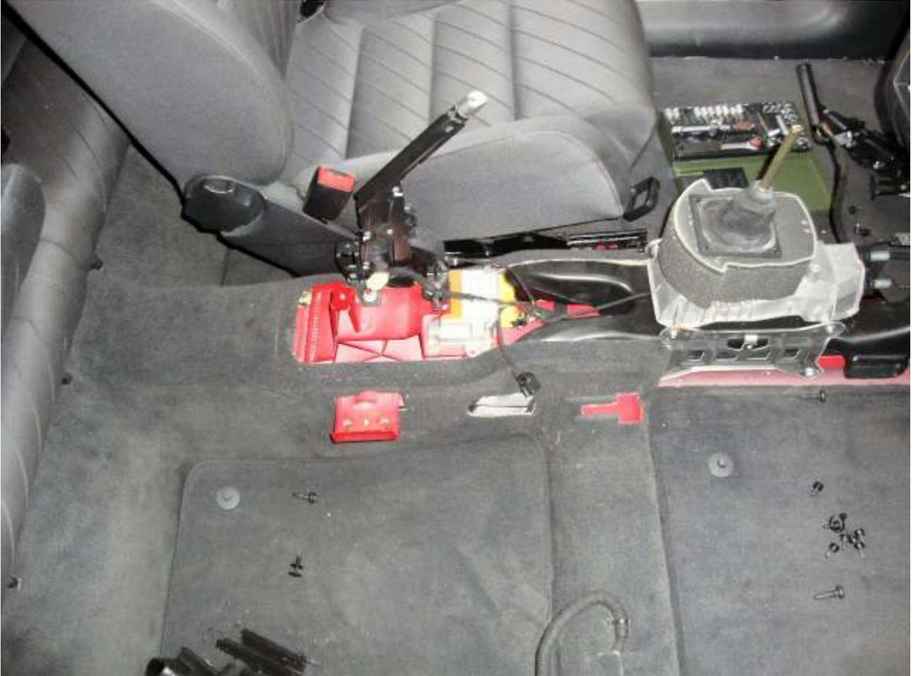
Muttern an Handbremskonsole und Stecker für Schalter lösen. Bolzen für Handbremsseil ziehen und Handbremshebel tauschen.
