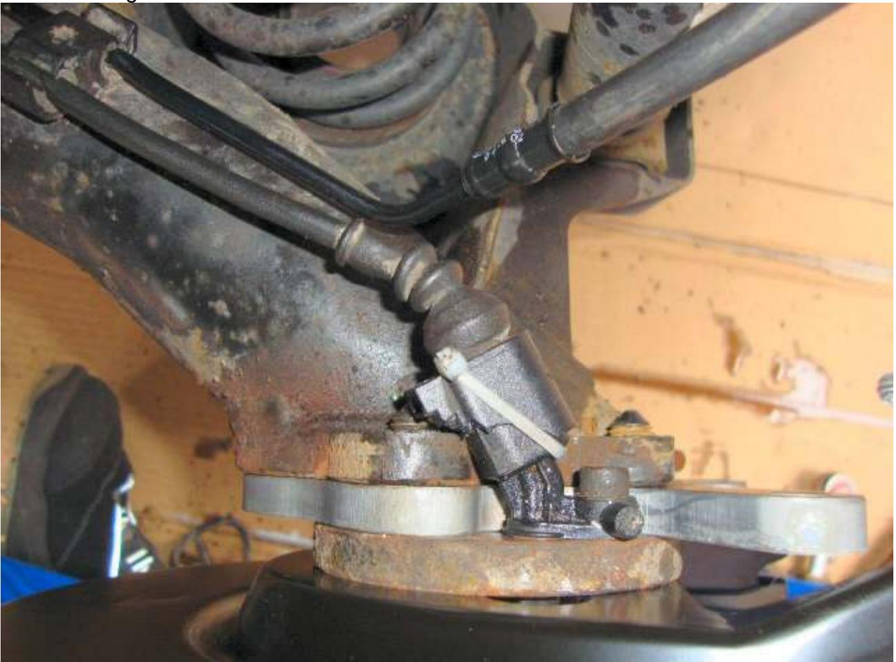
Radnabe wieder aufschieben und Doppelsechskantmutter mit 175Nm anziehen.
