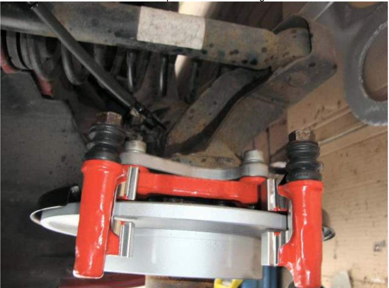
Bremssattel im ausgebauten Zustand vorentlüften bis Bremsflüssigkeit austritt.
