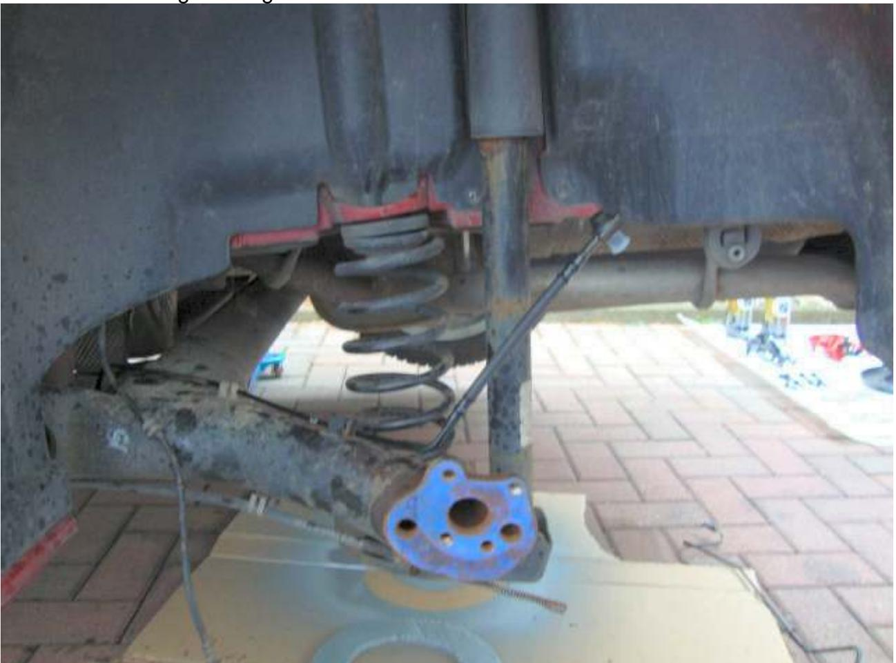
Deckblech, Achszapfen und Achszapfenaufn. an Hinterachse mit 30Nm+90° anziehen.
