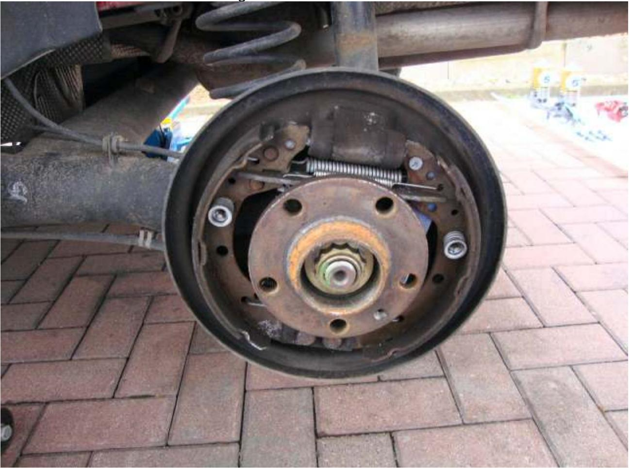
Abdeckkappe entfernen, Doppelsechskantmutter SW30 lösen und Radnabe abnehmen.
