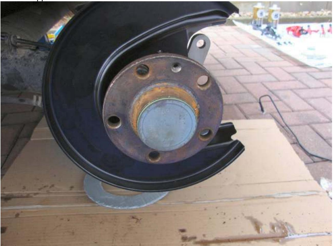
Bremsscheibe mit Torx-Senkschraube (4Nm) an Radnabe befestigen.
