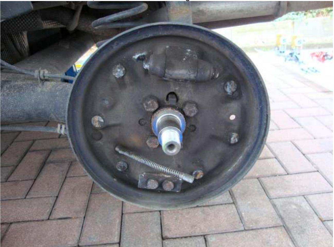
Anlagefläche an Hinterachse entrostet und abziehen.
