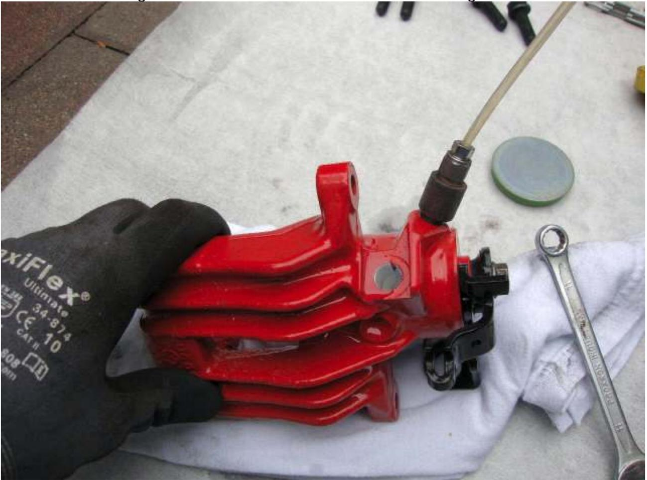
Bremsbeläge einlegen und Bremssattel mit 35Nm anbringen. Bremsleitung mit 35Nm anziehen.
