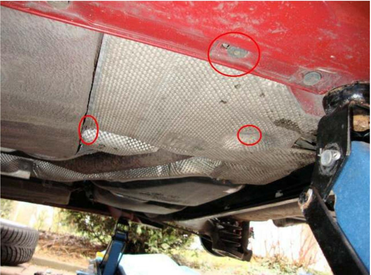
Handbremszug an gekennzeichneten Stellen aushängen.
