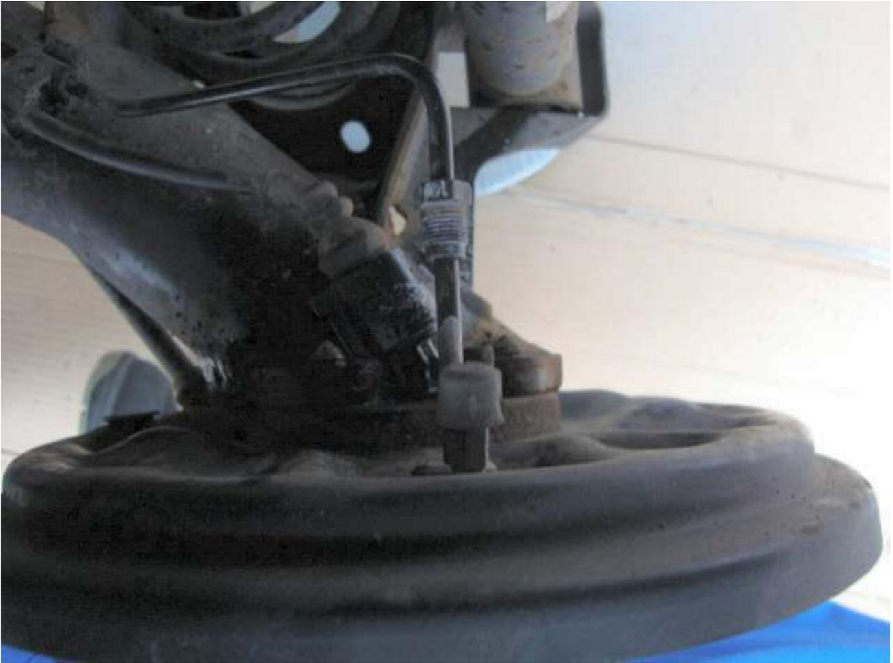
Bremsbacken abnehmen, 4x SW16 lösen und Trägerblech abnehmen.
