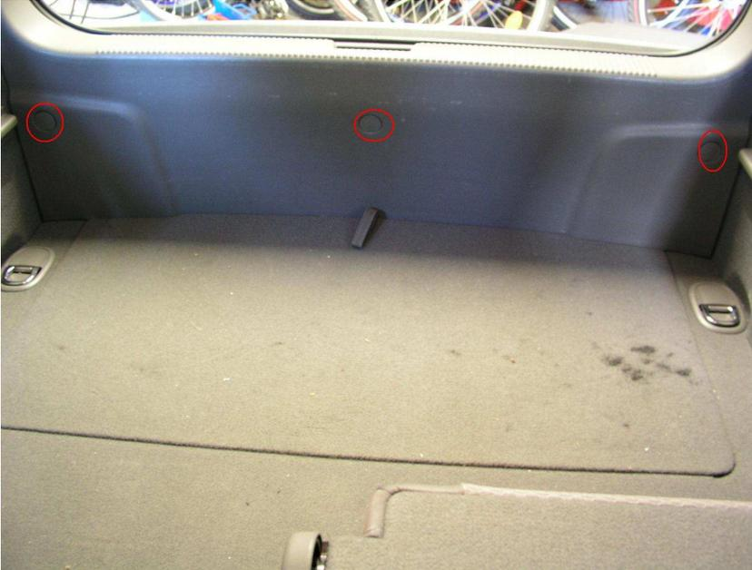
Hierzu die Bodenklappe öffnen, die Schraubenabdeckungen entfernen und die Abdeckung nach vorne oben abnehmen
