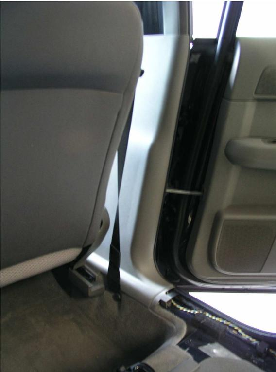
In den Schacht greifen, in dem der Gurt verschwindet und die Verkleidung abziehen.
