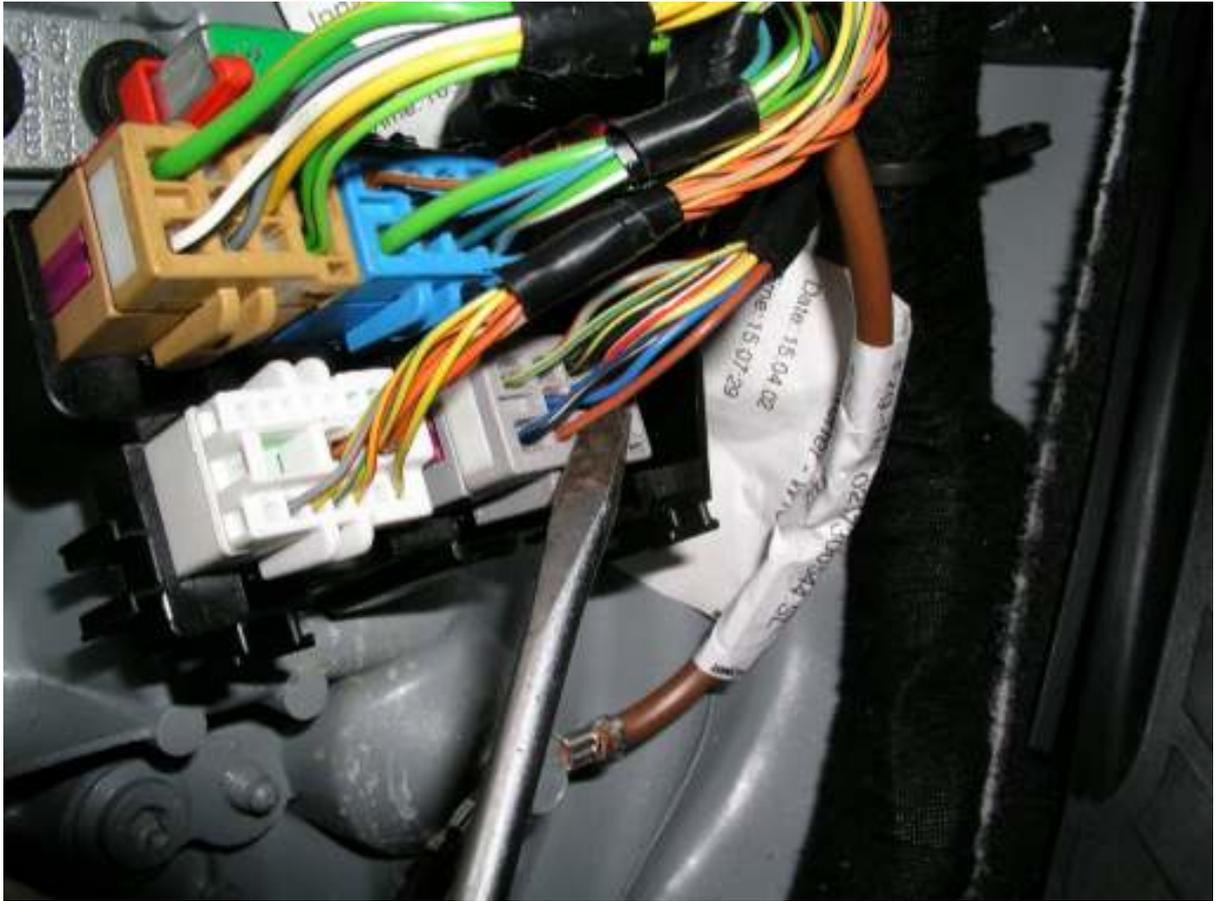
10. Weiße Entriegelung am Stecker eindrücken und Einzelleitung einstecken. Mit der Leitung zu den NSW verbinden.
