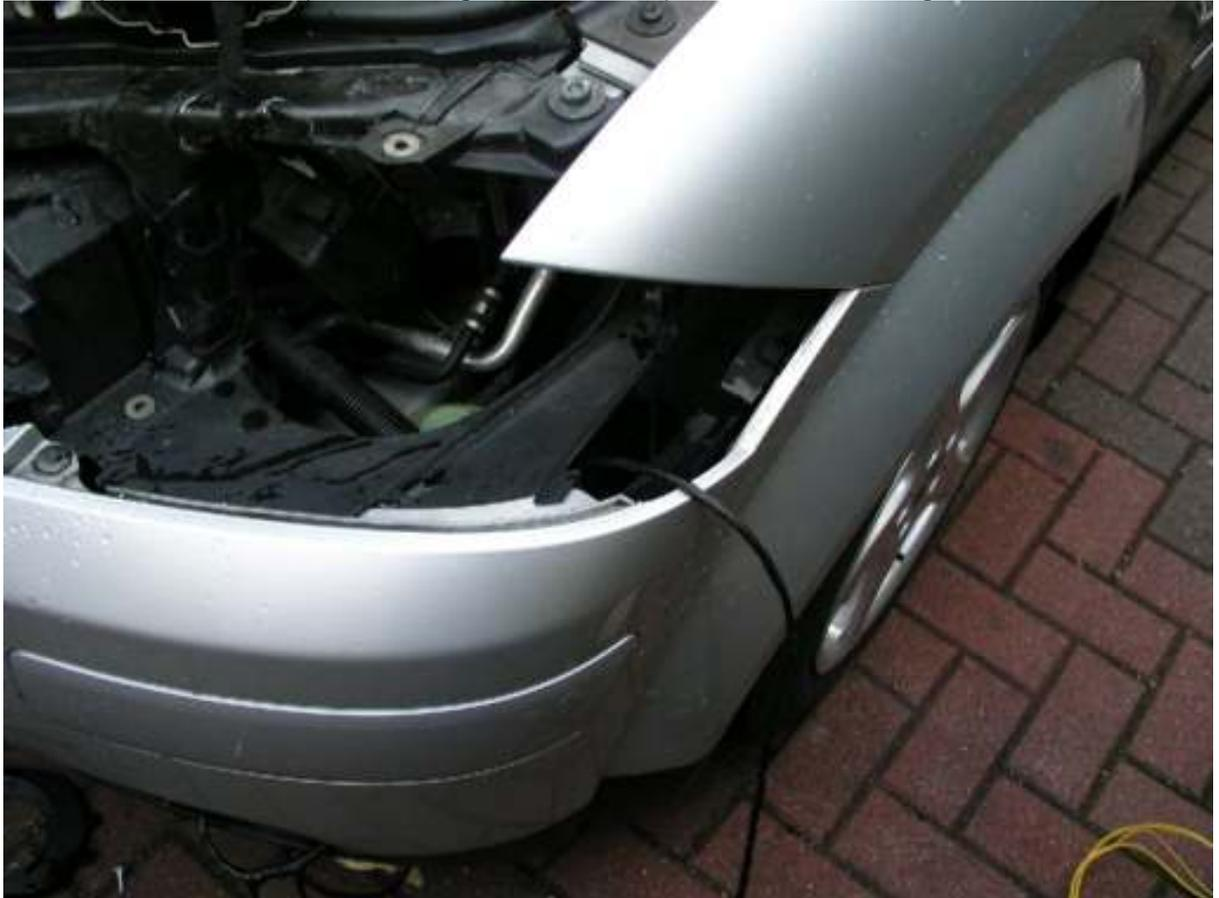
6. Mit der Einziehhilfe die Tülle rechts vom Scheibenwischer in den Innenraum durchstechen und Kabel einziehen.
