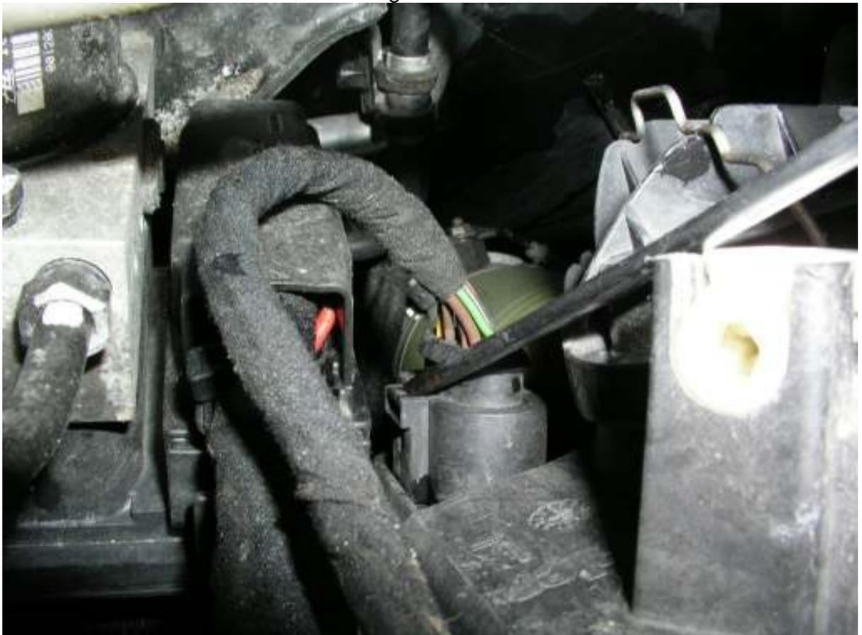
5. Kabelsatz im Kotflügel entlang der Wischwasserentlüftung verlegen. Guten Massepunkt suchen (z.B. Kotflügel Schrauben) und Masseleitung anschließen.
