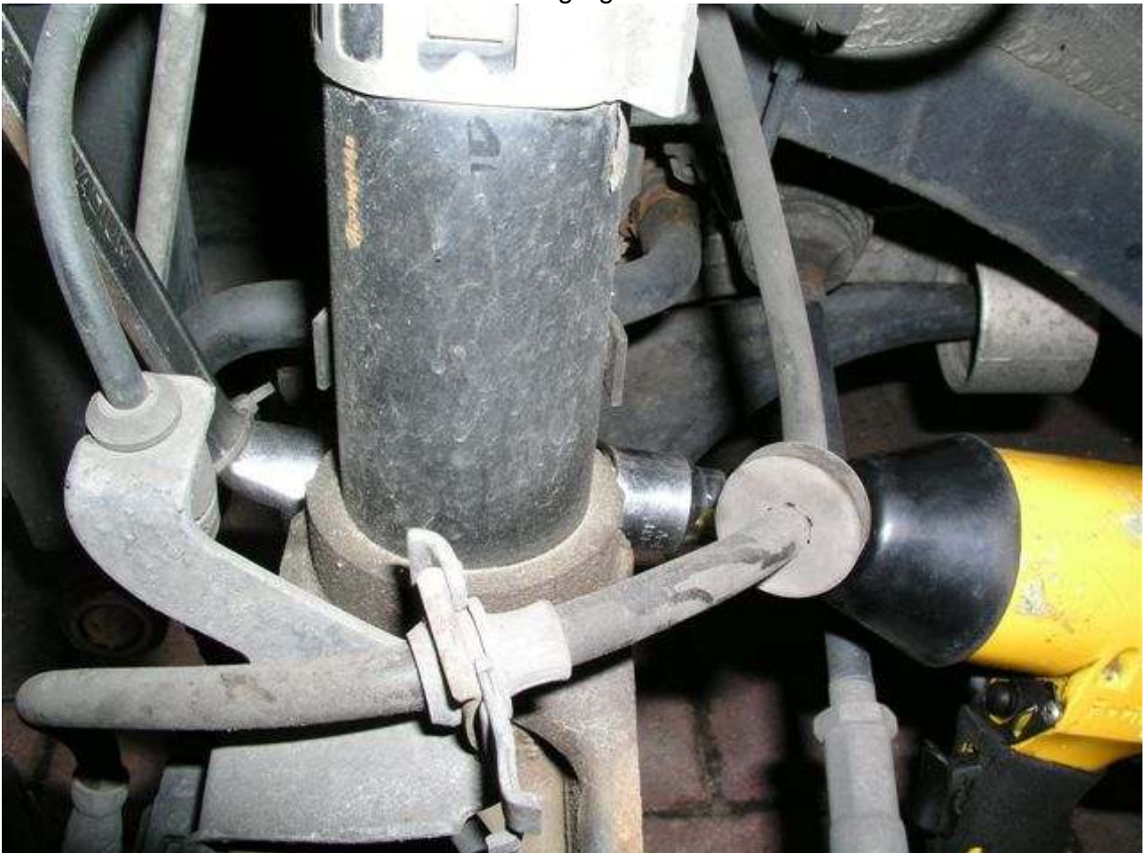
Mutter SW18 und Schraube SW18 im Radlagergehäuse lösen
