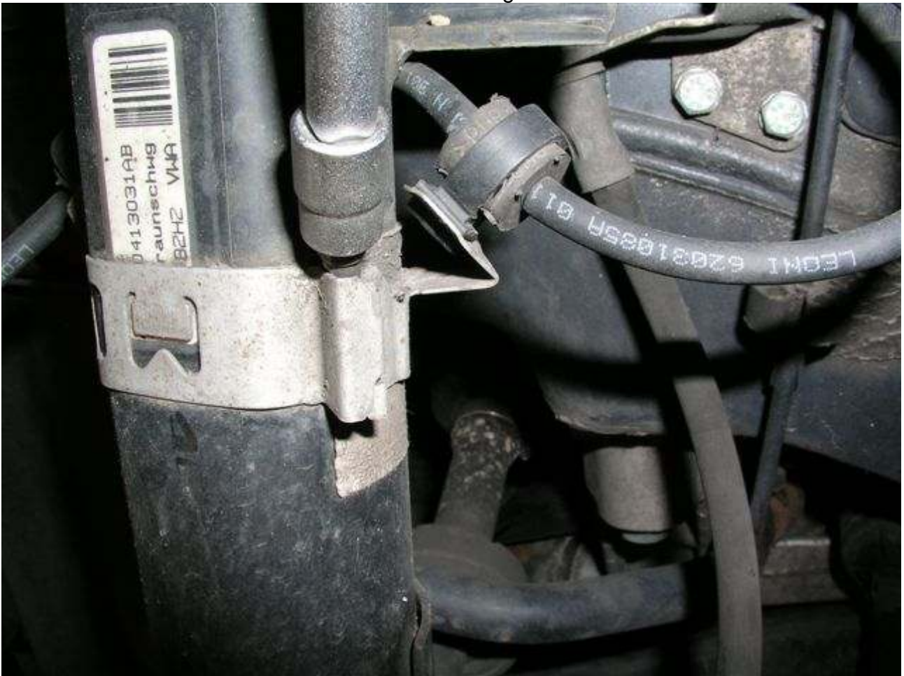
Halter für ABS Kabel mit Schraubendreher aushängen
