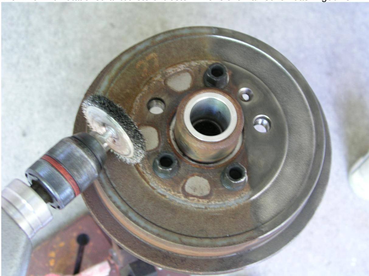
Trommel mit Bremsreiniger reinigen und entfetten
