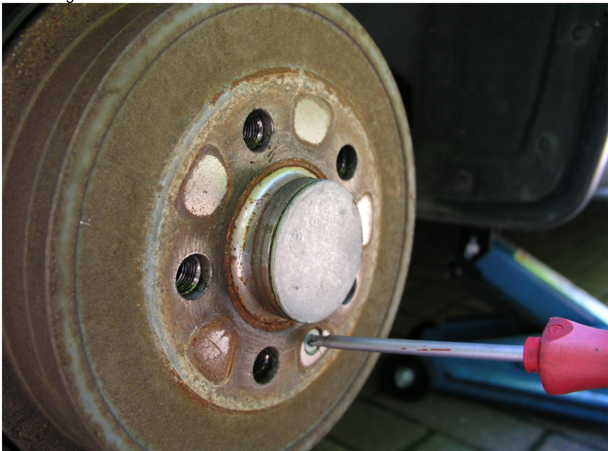
Trommel abnehmen. Evtl. einige Schläge mit dem Stahlhammer auf den Aussenring geben um die Trommel zu lockern.
