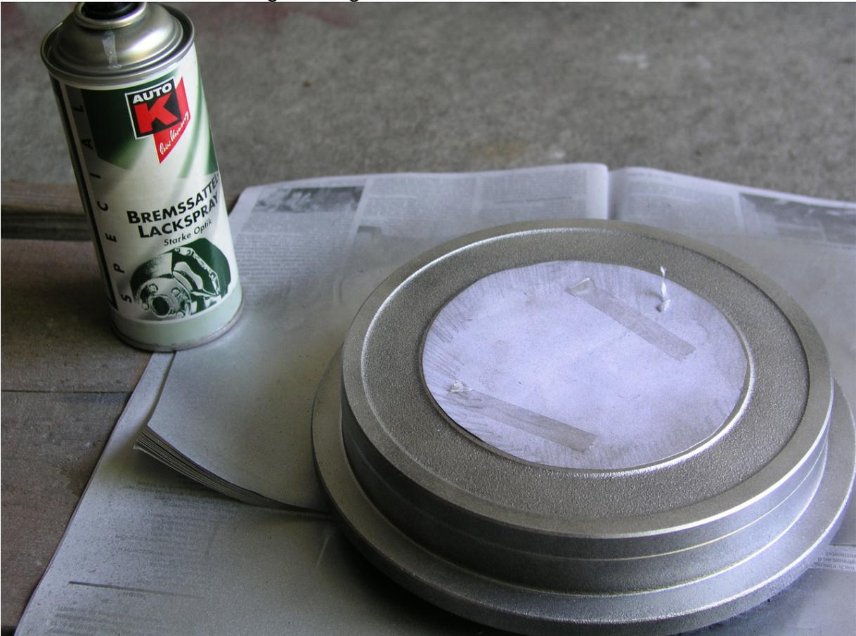
Trommel mit Bremsattellack im Kreuzgang lackieren.
