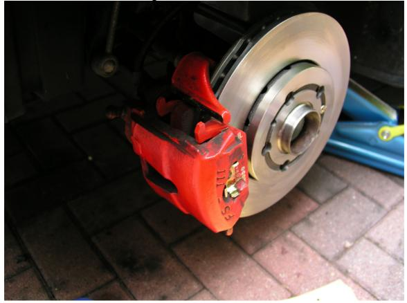
Führungsbolzen gründlich von Rost und Schmutz reinigen und Plastilube auftragen. Gewindeanfang mit Schraubensicherung benetzen
