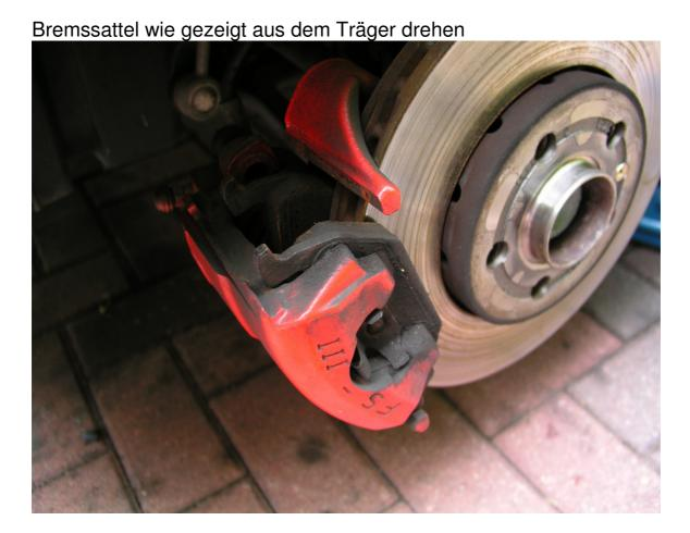
Achtung! Bremssattel auf keinen Fall am Bremsschlauch hängen lassen. Wie gezeigt am Federbein befestigen
