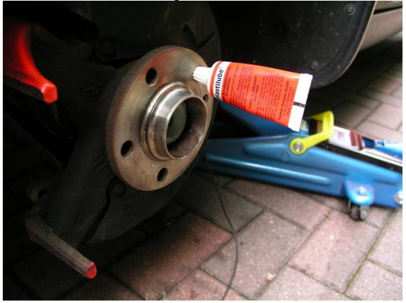
Bremsscheibe aufstecken und mit Schraube sichern. Nicht zu fest anziehen, da sie sich sonst nur noch schlecht lösen lässt.
