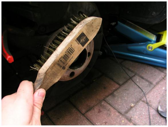
Bremsscheibe mit Bremsenreiniger von Fertigungsrückständen reinigen
