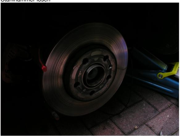
Radnabe gründlich mit der Drahtbürste reinigen
